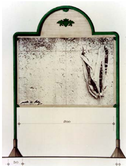
PROTOTIPO OD 10/90G MODELLO DI STENDARDO REALIZZATO IN TUBOLARE Ø 6 CM. CIRCA DI ALLUMINIO RINFORZATO E VERNICIATO CON AGGANCI A TERRA E CAMPANA COME PIEDE DI FINITURA. MODELLO DI STENDARDO SU MANIFESTO DI CM. 200X140
